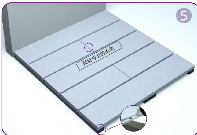
地板接缝处留出适当伸缩缝。边缘处，斜向打入螺丝以完成地板固定。
