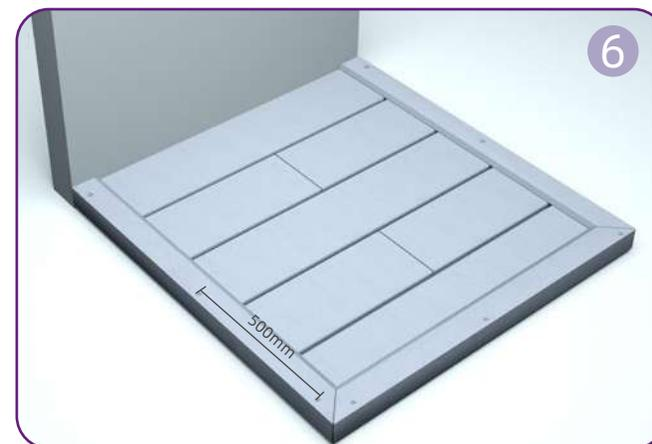
以合适的角度修剪L角并用螺丝钉固定。螺丝钉间距不超过500mm。
