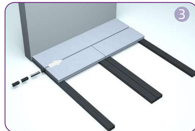
将连接件滑入地板槽中。
