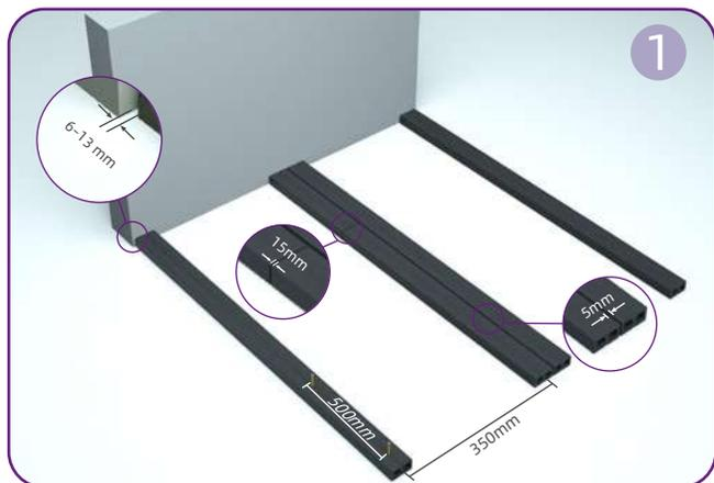
用膨胀螺丝将龙骨固定在地面上，龙骨间距不应超过 350 毫米。在地板之间的末端到接头处需要双龙骨。
