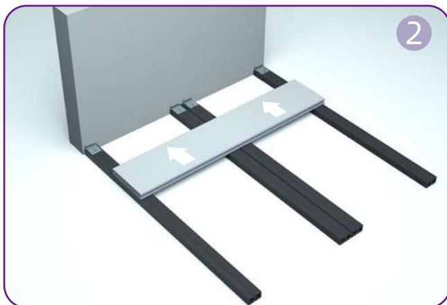
安装起始件并将第一个地板滑入起始夹。
